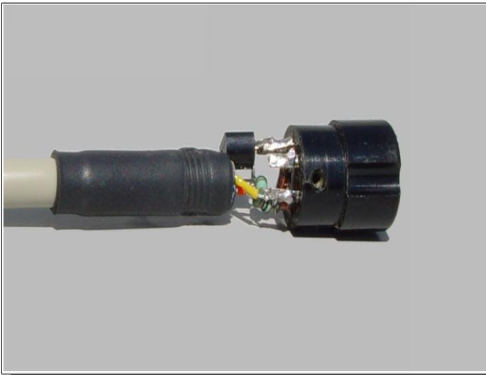
Wie in diesem Bild zu sehen, wurden hier die Bauteile im Mikrofonstecker untergebracht.
